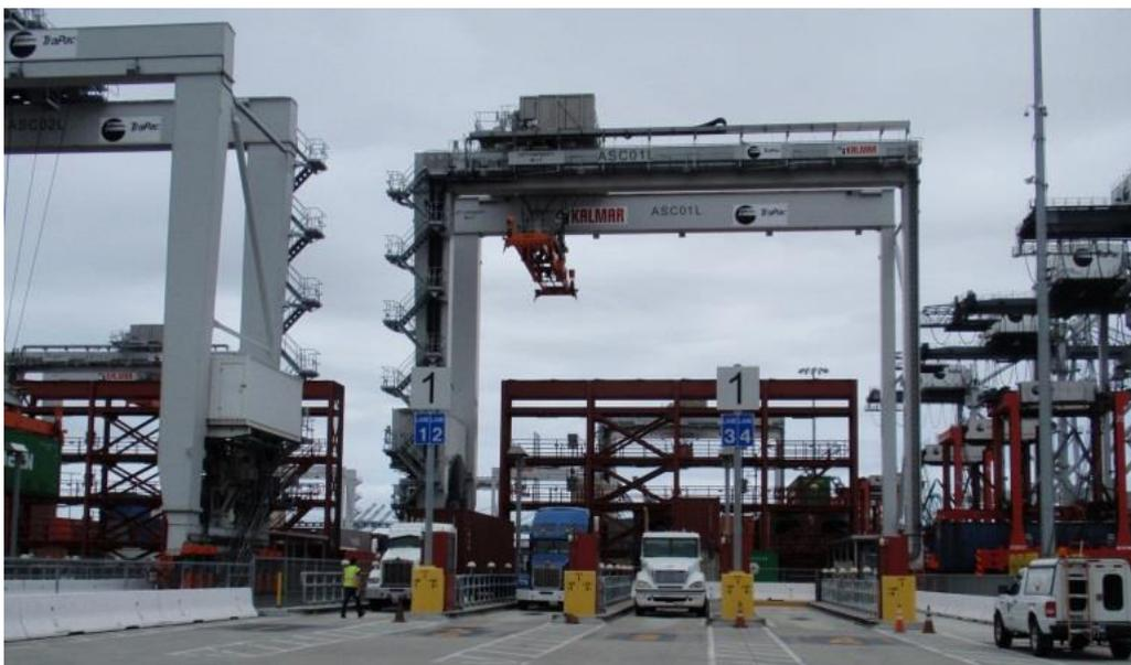
그림 35 ASC를 이용한 외래 새시로의 하역 작업
